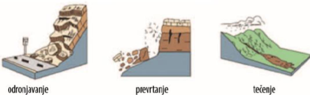
Slika 19: Prikaz osnovnih tipova klizanja prema mehanizmu kretanja
